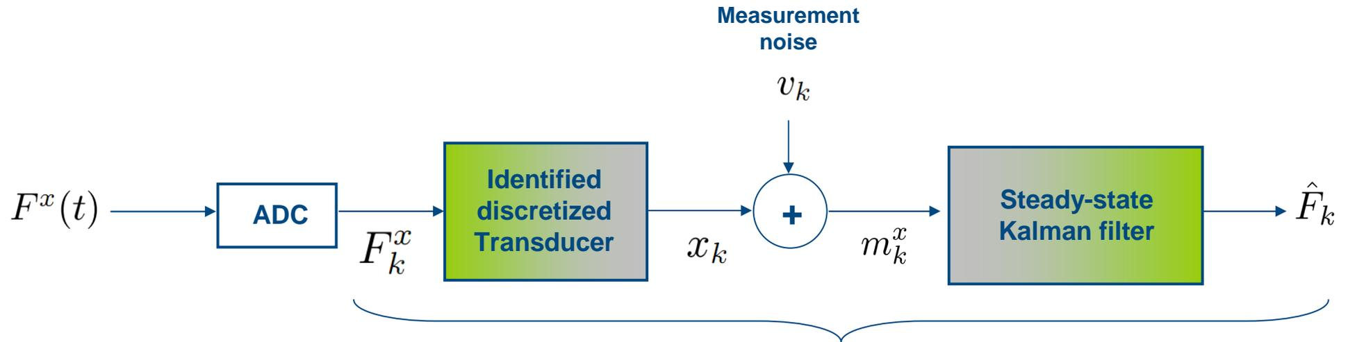
$$\mathcal{X}_k = \begin{bmatrix} X_k \\ \hat{X}_{k|k-1}^e \end{bmatrix} \quad \mathcal{X}_{k+1} = A_g \mathcal{X}_k + B_g \begin{bmatrix} F_k^x \\ v_k \end{bmatrix}$$
